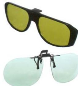
Suplementos tipo bisagra para su ajuste a diferentes tipos de gafa, básicamente modelos con montura tipo Horizon, Turbo, etc. Disponible en oculares IR3, IR5. Tratamiento antiarañazos y protección frente a trabajos de soldadura o protegerse de las radiaciones de infrarrojos en las fundiciones.
