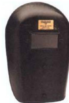
Pantalla de soldadura de mano fabricada en poliéster reforzado con fibra de vidrio. Cristal de visión de 110x55 mm. Filtro inactínico estándar tono 12.
