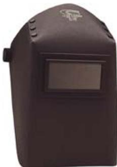
Pantalla de soldadura de cabeza fabricada en fibra vulcanizada indeformable. Cristal de visión de 110x55 mm. La pantalla se fabrica de forma estándar con un filtro inactínico de tono 12.
