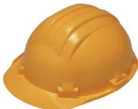
Casco básico fabricado en polietileno. Temperatura de trabajo  $-10^{\circ}\text{C} + 50^{\circ}\text{C}$ . Aislamiento eléctrico de hasta 440 V. Arnés en polietileno con 6 puntos de ajuste. Disponible en color amarillo, azul y blanc. Posibilidades en color rojo y verde bajo consulta. Certificado CE 397.
