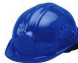
Casco de obra frontal plano, fabricado en polietileno de alta densidad, tratamiento anti UV, equipado de sudadera nomaz intercambiable. Arnés 6 puntos de ajuste fabricado en polietileno de baja densidad, ventilación lateral obturable en ambos lados. Disponible en colores azul y blanco. Certificado: CE 397.
