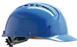
Casco fabricado en polietileno de alta densidad. Dispone de arnés de suspensión de cinta de poliéster (terylene) con 8 puntos de sujeción. Sudadera color piel Nomaz súper absorbente. Regulación Push and Twist Lok por rueda.
