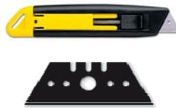
Para personas zurdas. Cuerpo del mango de aluminio. La hoja está cargada por resorte y desaparece automáticamente en el mango si el cuchillo se desvía del material a cortar y si no se bloquea el desplazador. ¡Durante el corte, el dedo pulgar se debe quitar del desplazador! Sencillo recambio de la hoja sin tener que emplear medios auxiliares empujando hacia atrás la parte interior. De seguridad certificada.
